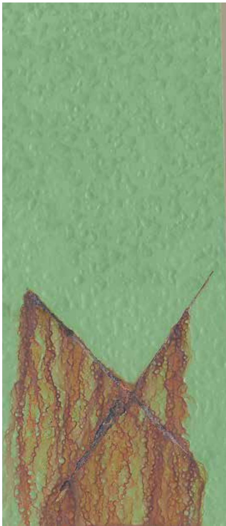
Dopo 400 ore di esposizione al test in nebbia salina secondo ISO 9227, si può notare la differenza tra il provino verniciato con il FONDO FINITURA SURFACE TOLERANT Serie 0440 Franchi e Kim (a destra) e un prodotto concorrente similare, presente sul mercato nel settore dell'anticorrosione.
